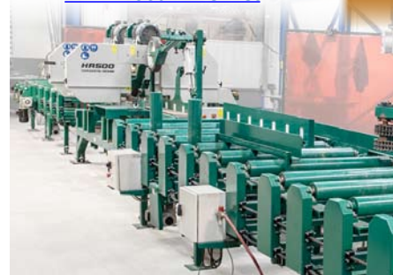
VODOROVNÁ PILA HR500 může mít až 6 řezných hlav
