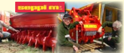
Lesní mulčovač MULTIFORST pro likvidaci nejen dřevní hmoty, ale též pro úpravu lesních cest a drčení kamenů až do průměru 15 cm - pro traktory o výkonu 150 koní
