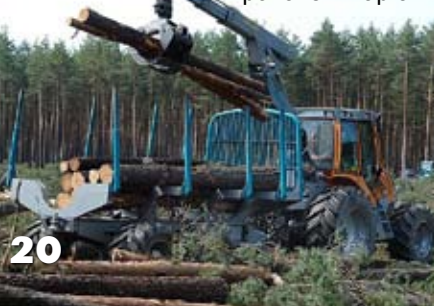
KOMBINACE speciál traktoru + 15 t vyvážecího vleku s mechanickým pohonem náprav
