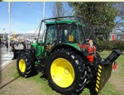
TRAKTOR JOHN DEERE 6220 s lesnickou nástavbou
