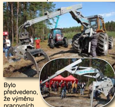
Lesní nakladač a tahač FELIX v čtyřkolovém (výše) a šestikolovém provedení
