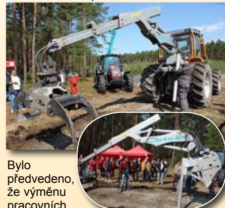
Lesní nakladač a tahač FELIX v čtyřkolovém (výše) a šestikolovém provedení
