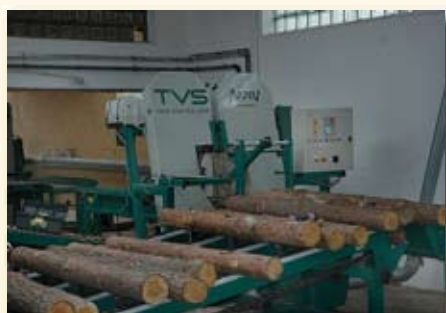
DRUHÉ pilařské pracoviště - v březnu 2008 uvedl Wood-Mizer na trh svůj systém zpracování malých kmenů (SLP - Small Log Processing). Toto zařízení ale pracuje v provozu LINDNER zkušebně už více než rok.
